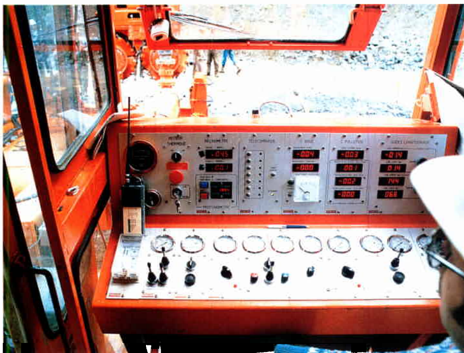
TABEAU DE BORD DE L'HYDROFRAISE - CONTROLE DE LA PERFORATION
